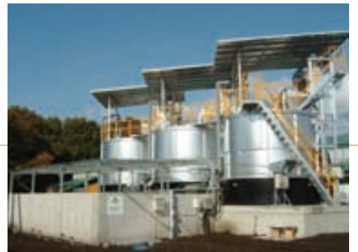
アンモニアの濃度を10分の1までに減らすことが出来る「ファイバーボール脱臭装置」
